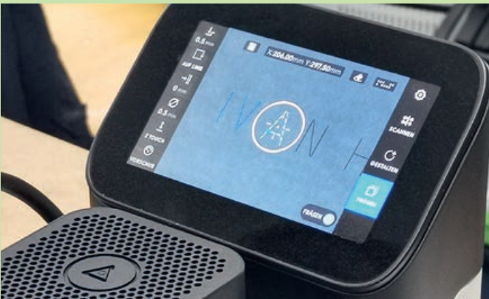
Blick auf das Display. Man sieht, wie die Origin die Buchstaben anvisiert und fräst.
